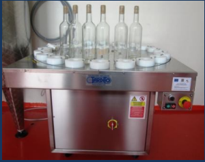
Instalație de spălat sticle
